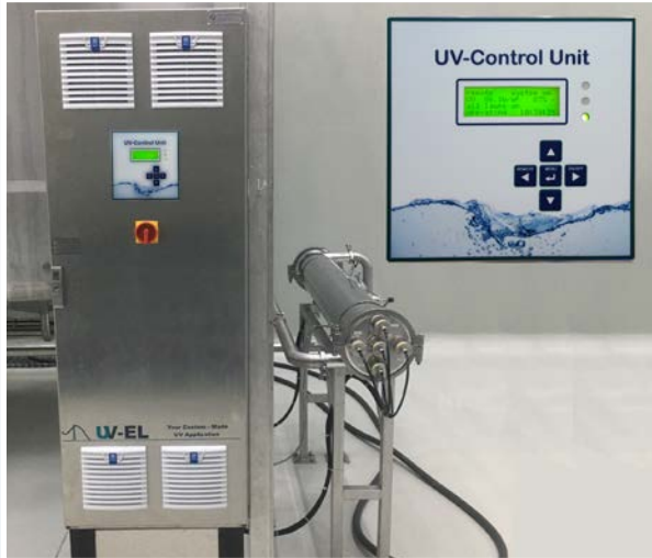
UV-Desinfektionsanlage von Zuckerlösungen mit sehr niedriger UV-Transmission Vietnam
