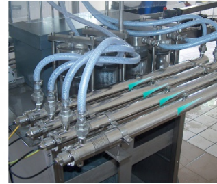
Desinfektion von Prozesswasser in der chemischen Industrie 4x VAP-AW 008 für 1m 3 /h Deutschland
