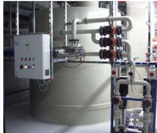
Reinstwasserbehandlung in der Solarindustrie UXP TC ME 121 für 20 m 3 /h Deutschland
